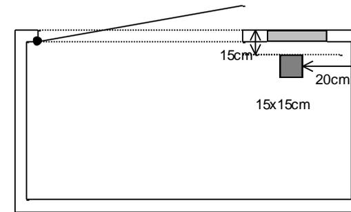
Bei den Boxen mit angegossenem Briefkastenabteil ist jeweils am Boden eine Aussparung von 15 x 15 cm zur Durchführung von Elektrokabeln. Immer in der Ecke, in der sich die Briefkastenanlage befindet, 20 cm von der Seite und 15 cm von vorne. Gemessen ab Außenkante Mülltonnenschrank.
